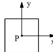
14.- El estado de esfuerzos en una partícula P de un material es el representado por el elemento de la figura. Si el material falla sobre el plano cuya normal es  $\hat{n}$ , cuando el esfuerzo de compresión normal a dicho plano es  $1000 \text{ N/m}^2$ ; determinar el máximo valor del esfuerzo  $\sigma_o$  para que no ocurra la falla del material y representar en un elemento del plano físico el par crítico.
