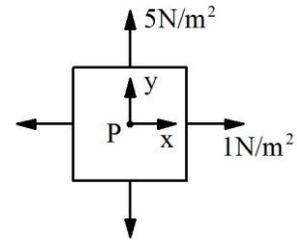
12.- En la figura se muestra el estado de esfuerzos en una partícula P de un cuerpo; determinar el estado de esfuerzos en la partícula, correspondiente a los planos perpendiculares a los ejes xy.
