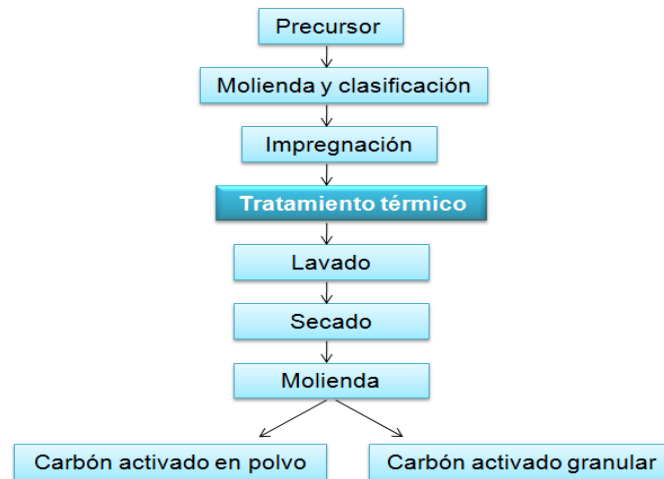
Figura 5. Diagrama del proceso de activación química [21].
