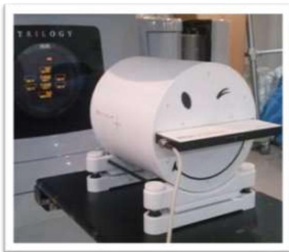
Fig. 3.2. Maniquí Octavius 4D y Arreglo Planar de Cámaras ionización Octavius detector 729
