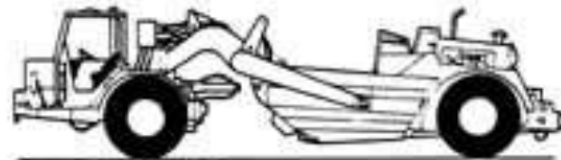
Convencional de dos motores
