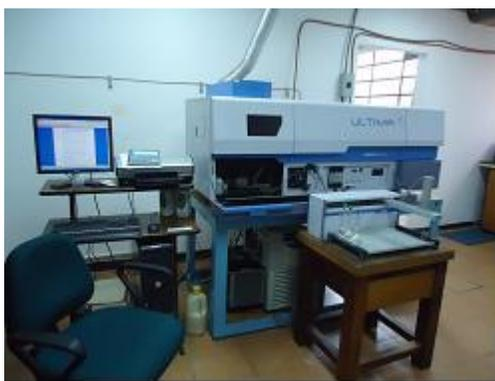
Equipo plasma ULTIMA.2 utilizado para la cuantificación de cationes: Ca, Mg, Na, K, Cu, Zn, Fe, Mn y Mo.
