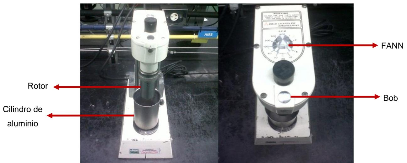
**Figura 38.** Viscosímetro rotatorio modelo CHAN 35 marca EG&G CHANDLER Engineering ®.
