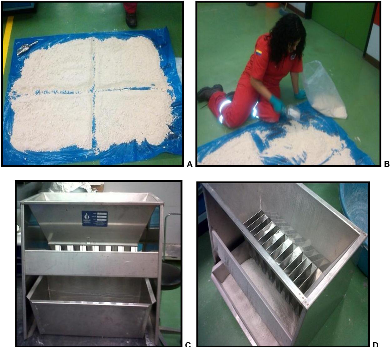
**Figura 15.** Cuarteado de la muestra. A-muestra mezclada y dividida; B-Recogiendo la muestra de reserva; C y D-Cuarteador Jone utilizado.
