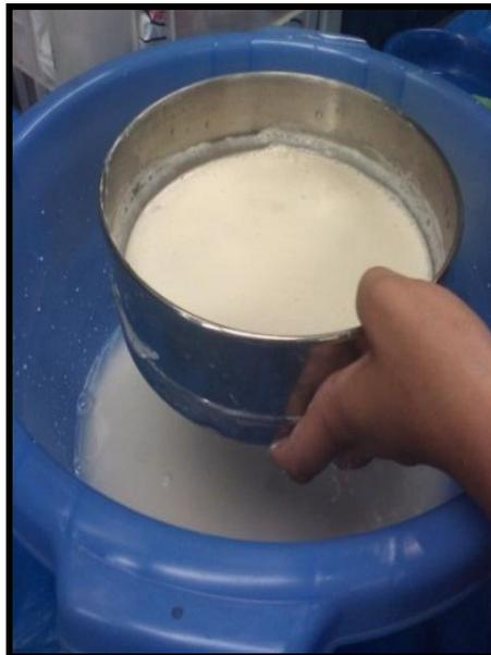
**Figura 16.** Tamizado vía húmeda de la muestra (tamiz 325 mallas).
