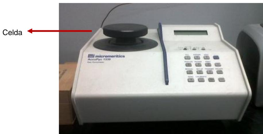
**Figura 36.** Picnómetro de helio a utilizar AccuPyc II modelo 1330 Micromeritics ®.
