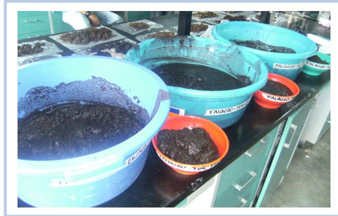
Figura 11: Muestras de turba colocadas en bañeras plásticas para facilitar su secado al aire.
