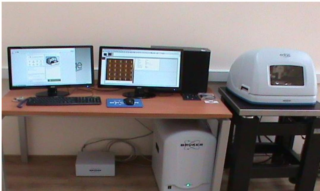
**Figura 14:** Equipo de Microscopía de Fuerza Atómica "The Dimension Edge".<sup>22</sup>
