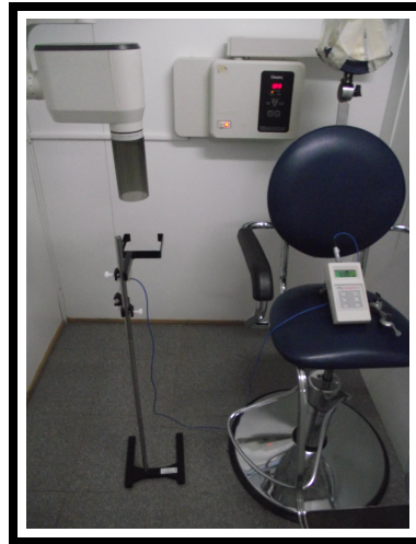
Figura 6.8: Montaje experimental para la medición de CHR sin lámina.
