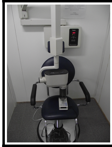
Figura 6.7: Montaje experimental para medición de voltaje de tubo.
