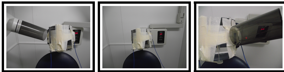
Figura 6.14: Montaje experimental utilizado para la medición del kerma en la superficie de la piel utilizando una cámara de ionización tipo lápiz, un detector de estado sólido y un fantoma de PMMA.
