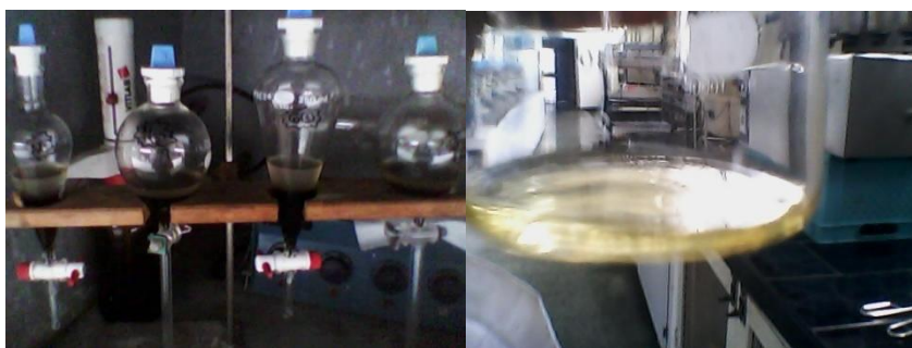
FIGURA 17. Extracción de grasa del almidón de arroz utilizando solventes orgánicos.
