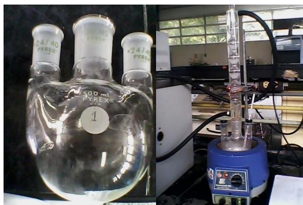
FIGURA 18. Equipo para la determinación de la absorción de agua, solubilidad y poder de hinchamiento del almidón de arroz.
