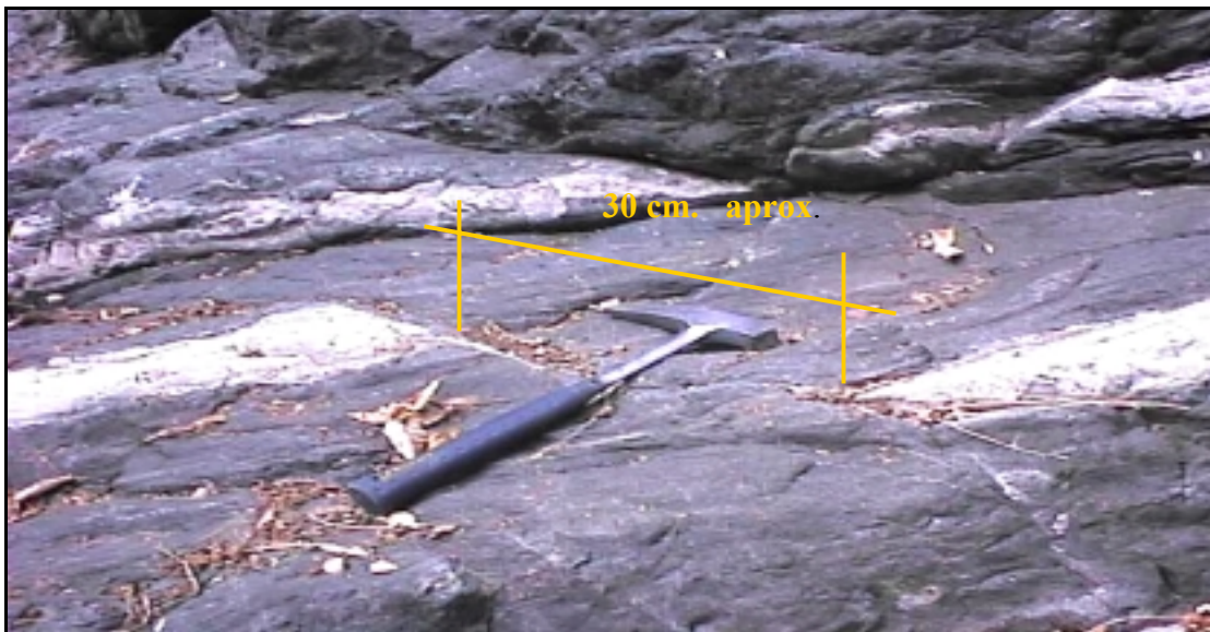
Figura 4.44. Fotografía azimuth 048°, con una inclinación de 32°N. Muestra el afloramiento D3, donde se presenta el desplazamiento de la falla f5 (aproximadamente 20 cm).
