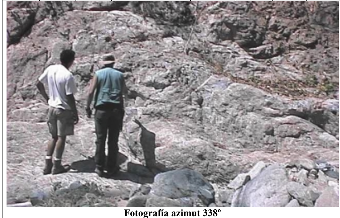
Figura 4.85. Fotografía de la estación de trabajo L1 en la quebrada Guanape. Puede observarse un espejo de falla en una litología de augengneis.
