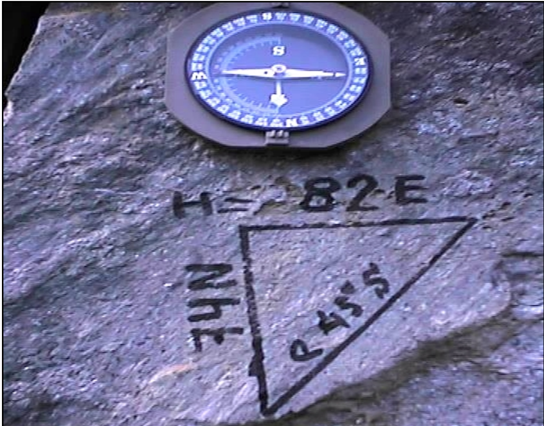
Figura 4.51. Fotografía azimut 168°. Detalle de un plano de falla de la estación F1, del río Cerro Grande, se muestran los datos tomados sobre el plano de falla, incluyendo el cabeceo (pitch) de la estría.
