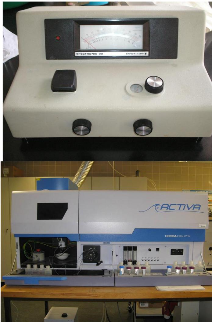
**Figura 35:** Foto del espectrofotómetro Spectronic 20 y del espectrofotómetro de emisión atómica con fuente de plasma inductivamente acoplado ICP-AES empleados en los análisis de las muestras
