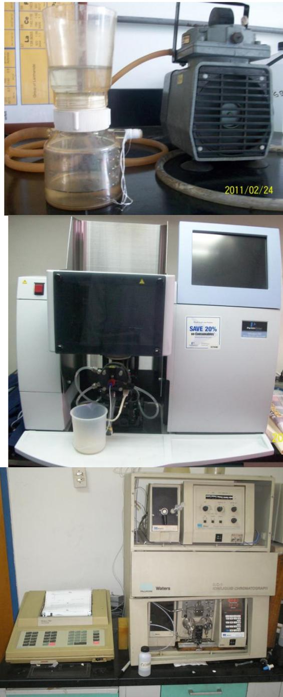
**Figura 34:** fotografía del montaje de filtración de muestras, equipo de absorción atómica, y cromatógrafo iónico empleado en los análisis.
