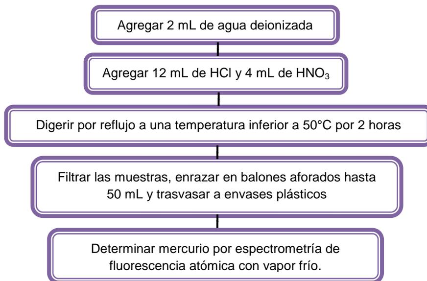
**Figura 11.** Esquema del tratamiento químico de las alícuotas de los sedimentos a analizar.
