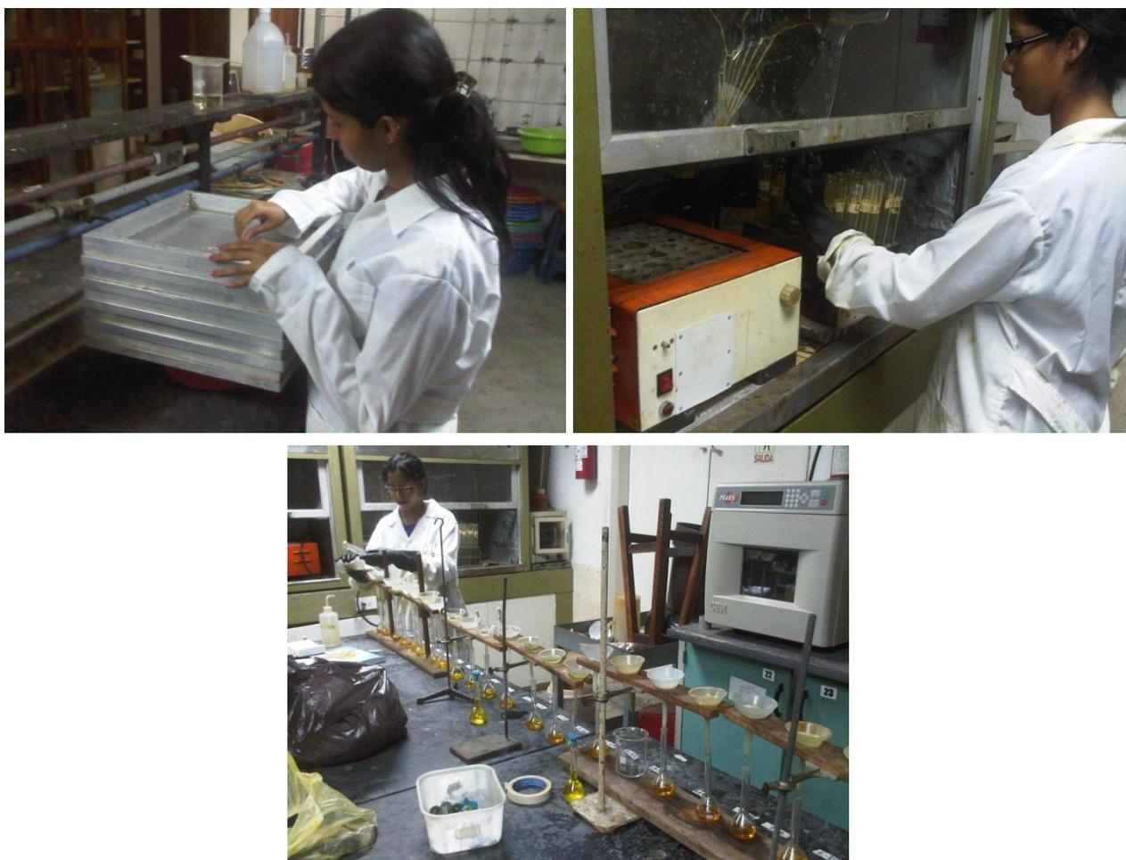
**Figura 8.** Imágenes que esquematizan las labores de tamizado, digestión ácida por reflujo y filtración de las soluciones obtenidas durante dicha digestión.
