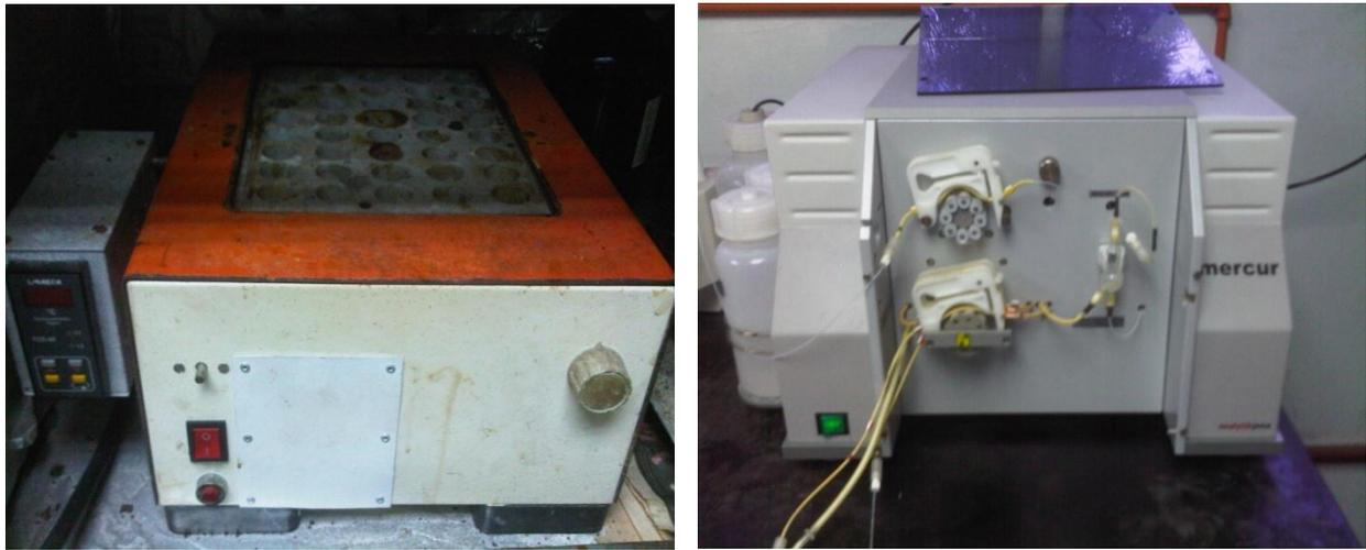
**Figura 12.** Equipos empleados para la determinación de mercurio: a) Digestor por refluo y b) Espectrómetro de fluorescencia atómica.
