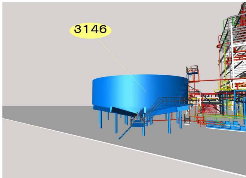
Figura 2.12 Vista de un tanque y su conexión con el *Piperack*
