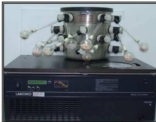
**Figura 7.** Liofilización de las muestras de tejido e hígado de peces
