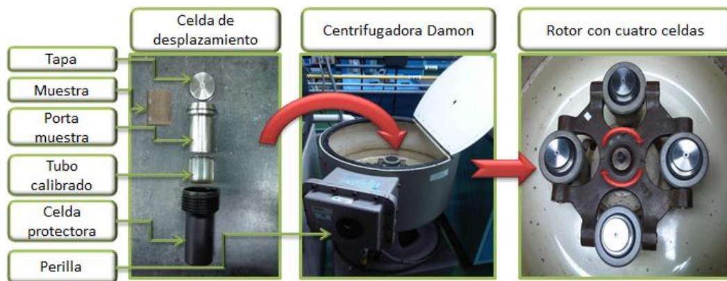
Figura 3.18. Proceso de centrifugación 100% saturación.
