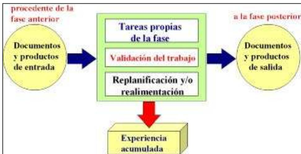
**Figura 8. Esquema general de operación de una fase del ciclo de vida**
