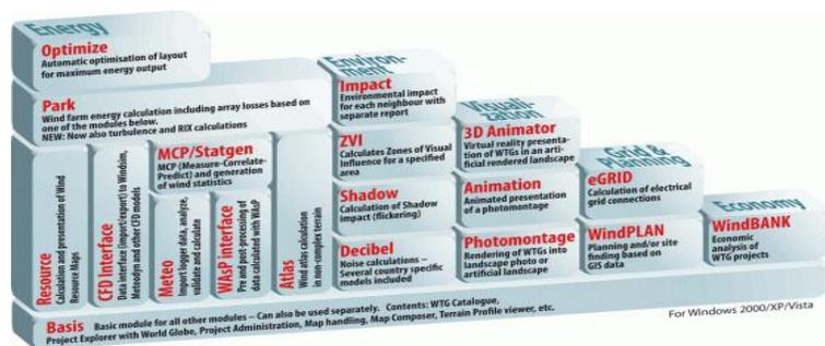
Figura 9.- Módulos del software WindPRO<sup>22</sup>
