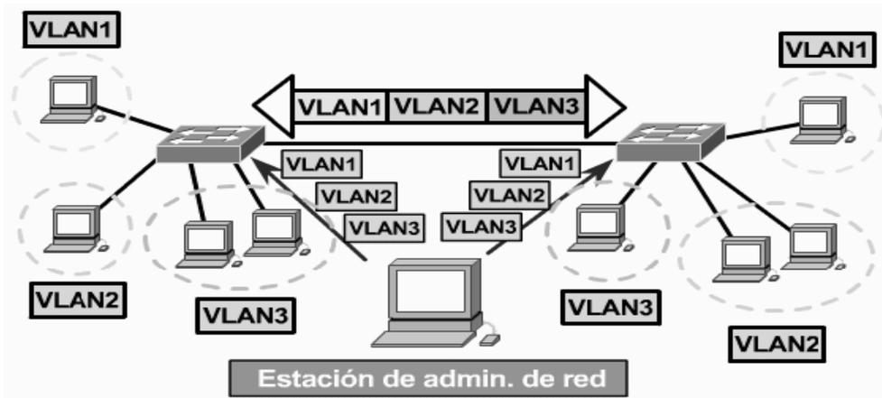
Figura # 5. Ejemplo de una VLAN estática. (Tomado de CCNA – CNAP Eduardo Collado)
