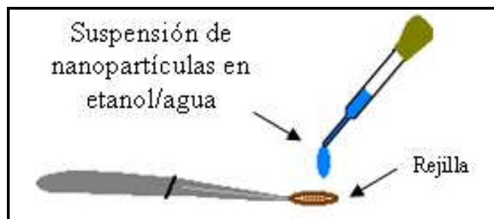
Figura 24 Preparación por suspensión por vía húmeda de las muestras para observarlas por MET.
