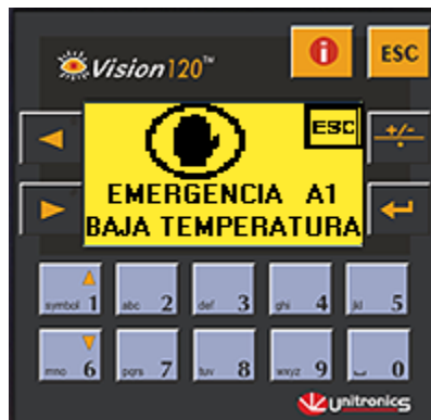
Figura 57. Pantalla de parada de emergencia (baja temperatura).
