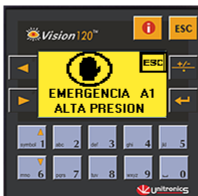
Figura 56. Pantalla de parada de emergencia (alta presión).
