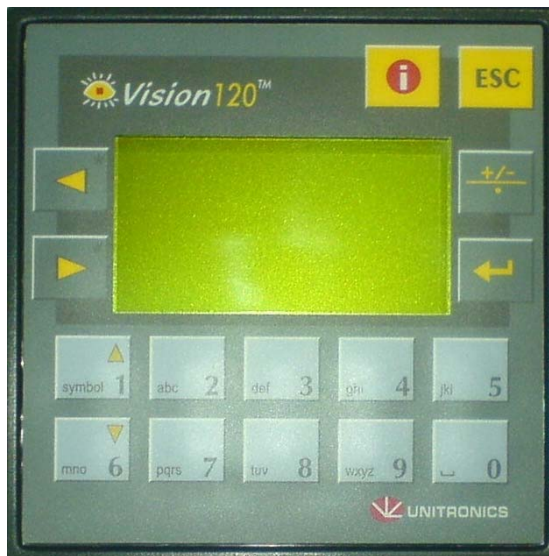
Figura 24. Controlador lógico programable Unitronics Vision120.
