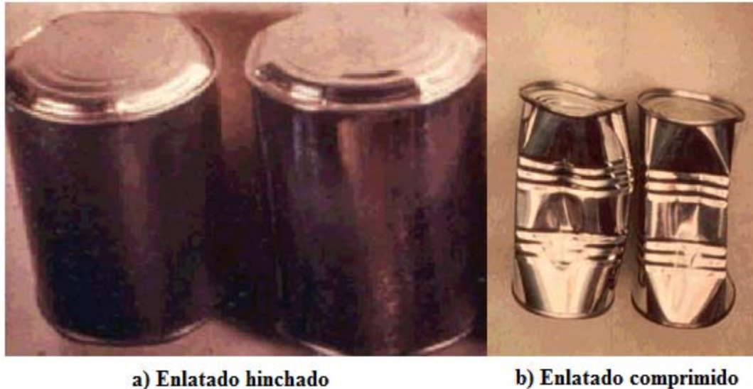
Figura 2. Deformaciones en los envases del producto por mala despresurización durante el enfriamiento. a) y b).
