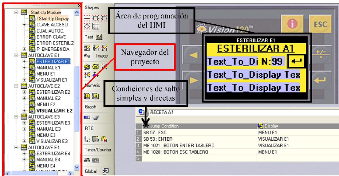
Figura 36. Pantallas en el navegador del proyecto y de programación de una pantalla.
