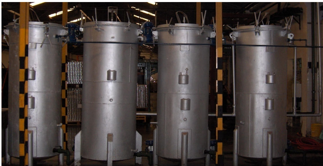
Figura 1. Esterilizadores para productos alimenticios enlatados.
