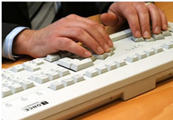
Figura 2.3. Teclado Braille fabricado por la UAB y la ONCE.
