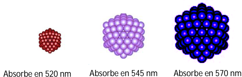
Figura 14: Variación de la longitud de onda del PS de las Nps de oro en función del tamaño de las partículas [39] .
