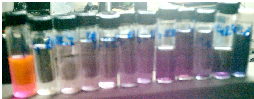
Figura 76: Complejos de Nps de oro-RB-SDS, sintetizados bajo las siguientes condiciones experimentales: 135.0 mJ, 2.14 GW/cm 2 , concentración de 0.045 M de SDS, 9.0 \times 10^{-07} M de RB en cada uno de los viales y tiempos de ablación de izquierda a derecha: 1, 2, 4, 6, 8, 10, 12, 14, 15, 17 y 20 minutos. El primer vial a la izquierda de la foto contiene una solución acuosa (blanco) de RB-SDS.
