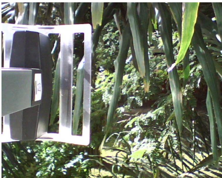
Figura Anexos 8: Obstáculos en el camino de las señales RF de la antena “Ant2”
