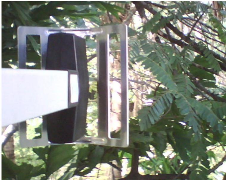
Figura Anexos 6: Obstáculos en el camino de las señales RF de la antena “Ant1”
