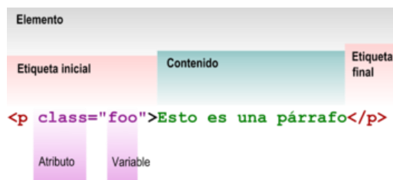
Estructura general de una línea de código en el lenguaje de etiquetas HTML
