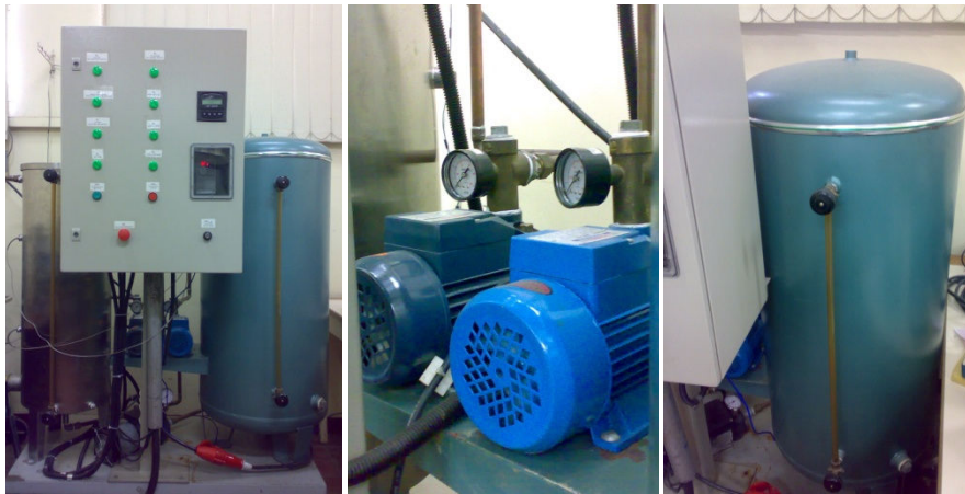
Figura 29. Maqueta, Bomba de Vaciado (Azul claro) y Tanque de depósito.
