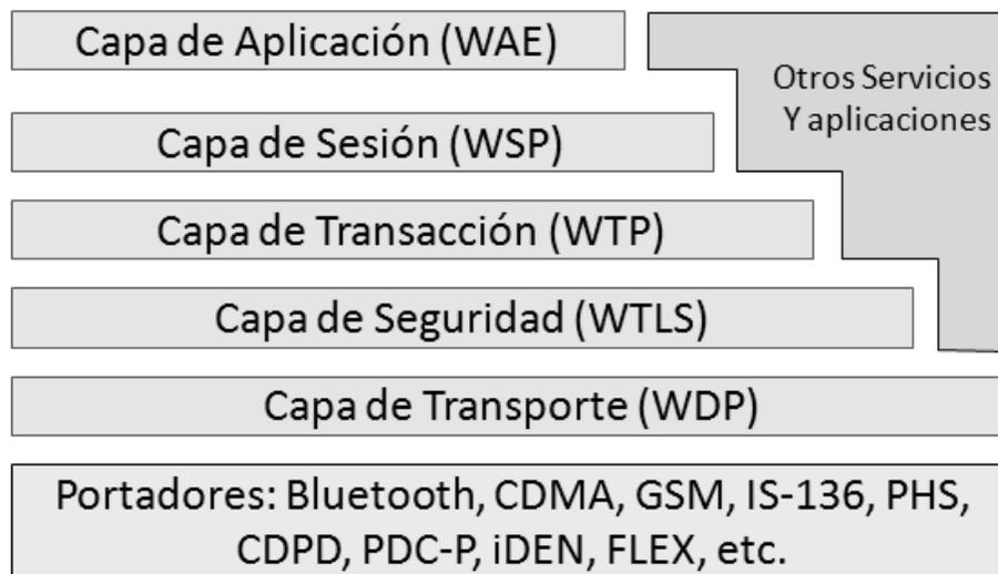
**Figura 2.17 Pila de protocolos WAP.**
