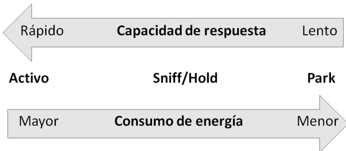
Figura 2.7 Comparación de modos de conexión.
