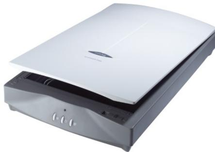
**Figura 2.2: Escáner plano**
