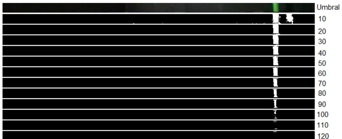
Figura 5.18. Fondo negro, fuentes de iluminación de baja intensidad. Operaciones aplicadas: sustracción de fondo y umbralización (umbral:10-120).
