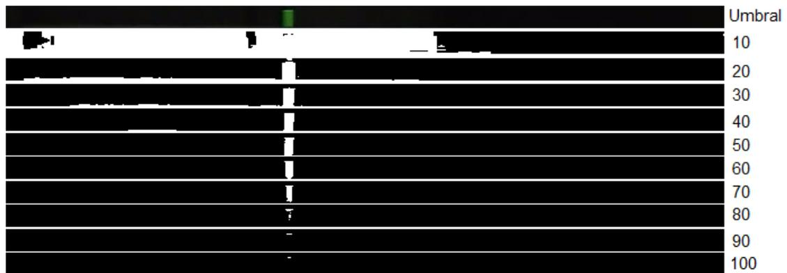
Figura 5.17. Fondo negro, fuentes de iluminación de alta intensidad. Operaciones aplicadas: sustracción de fondo y umbralización (umbral:10-100).
