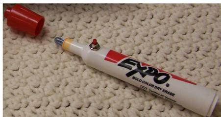
Figura 3.9. Lápiz infrarrojo, construido con materiales de bajo costo.
