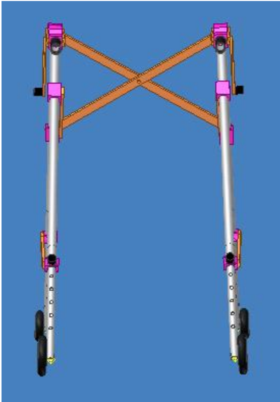
Figura N° 20. Vista frontal. El ancho mayor de la andadera es de 59 cms a nivel de las ruedas, lo cual permite el paso por una puerta promedio (75 cms.).
