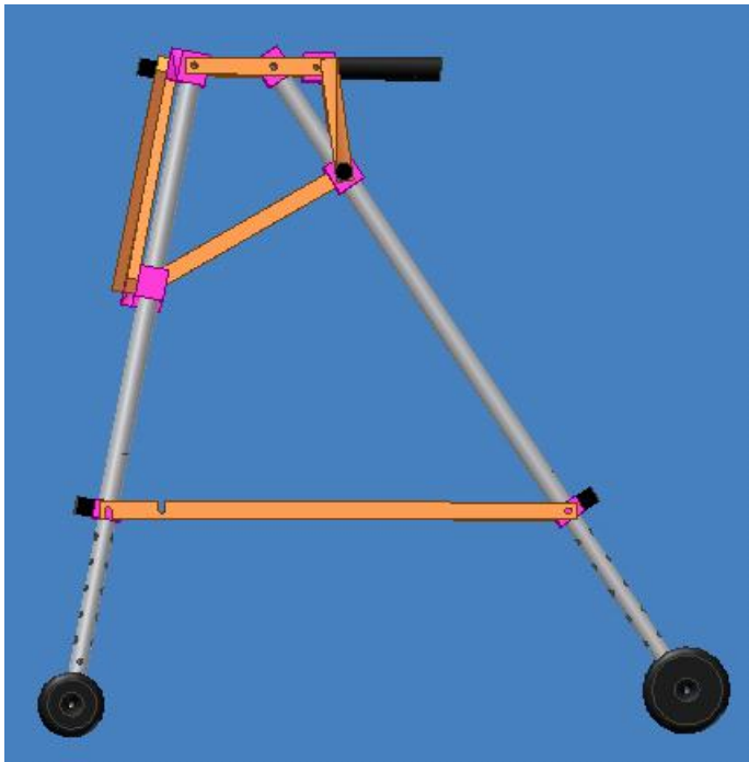
Figura N° 19. Vista de perfil. Se observa la inclinación de 10^\circ de los tubos traseros, para brindarle mayor comodidad al usuario. También se observa que las empuñaduras se encuentran completamente horizontales.
