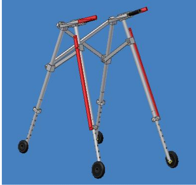
Figura N° 16. La andadera se comienza a cerrar al retirar las barras mostradas en rojo que rigidizaban el marco. Note que ahora las pletinas traseras pueden cerrarse como una tijera ya que el sistema queda sin vínculos.
