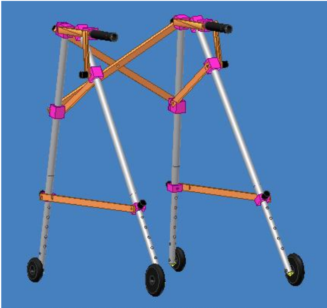
Figura N° 15. Modelo propuesto de andadera que cumple con los requerimientos de diseño.
