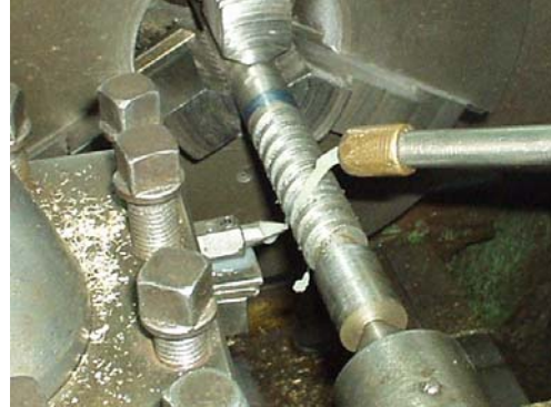
Figura N° 52 (izquierda): Roscado de la Zona 3 del Tornillo PV. Figura N° 53 (derecha): Lubricación en el roscado de la Zona 3 del Tornillo PV
