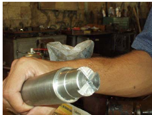
Figura N° 48 (izquierda): Muesca previa al fresado. Figura N° 49 (derecha): Fresado del extremo superior del Tornillo
