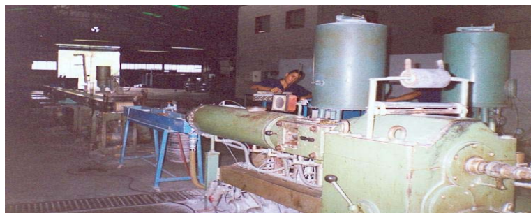
Figura 72: extrusora con refrigeración y bandas transportadoras
