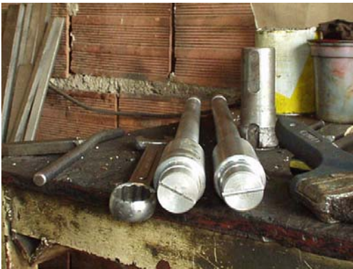
Figura N° 48 (izquierda): Muesca previa al fresado. Figura N° 49 (derecha): Fresado del extremo superior del Tornillo
