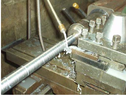
Figura N° 46 (izquierda): Acción de la Herramienta de corte en la torreta mientras se ejerce la lubricación. Figura N° 47 (derecha): Utilización de la Torreta y el Centro-punto.
