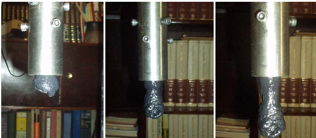
Figura N° 59 (izquierda): Inicio de producción continua axial. Figura N° 60 (centro): Desarrollo de la producción continua axial. Figura N° 61 (derecha): Efecto del calentamiento gradual del molde durante la producción
