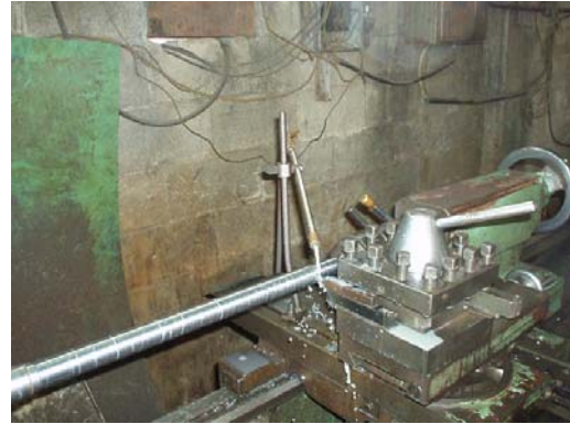
Figura N° 46 (izquierda): Acción de la Herramienta de corte en la torreta mientras se ejerce la lubricación. Figura N° 47 (derecha): Utilización de la Torreta y el Centro-punto.
