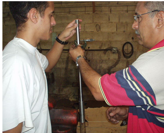
Figura N° 42 (izquierda): Medidas de las barras brutas mediante Calibrador de Vernier. Figura N° 43 (derecha): Medidas de las barras brutas mediante tornillo micrométrico
