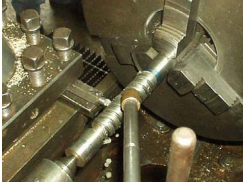
Figura N° 52 (izquierda): Roscado de la Zona 3 del Tornillo PV. Figura N° 53 (derecha): Lubricación en el roscado de la Zona 3 del Tornillo PV
