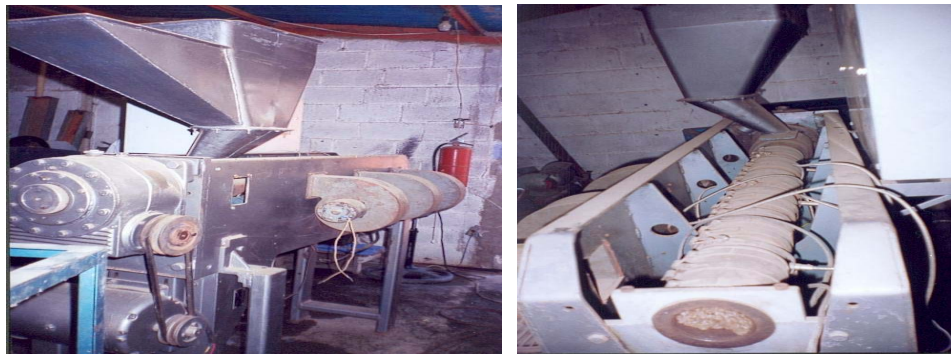
Figura 69 y 70: control de temperatura por resistencias y ventilación
