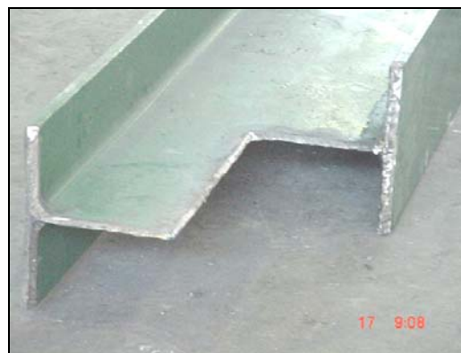
Figura A.42 Corte de viga HEA-360.
