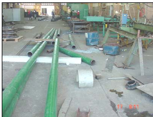
Figura A.51 Corte de tuberías que formarán la cercha.
