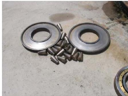
Rodamiento cónico inferior del eje principal desarmado
