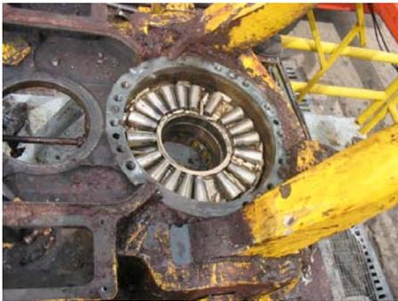
Rodamiento cónico inferior del eje principal
