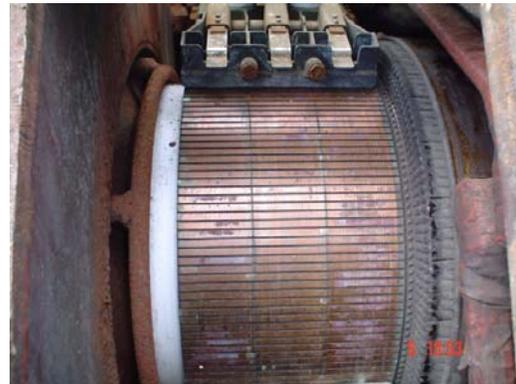
Rotor de un motor eléctrico DC
