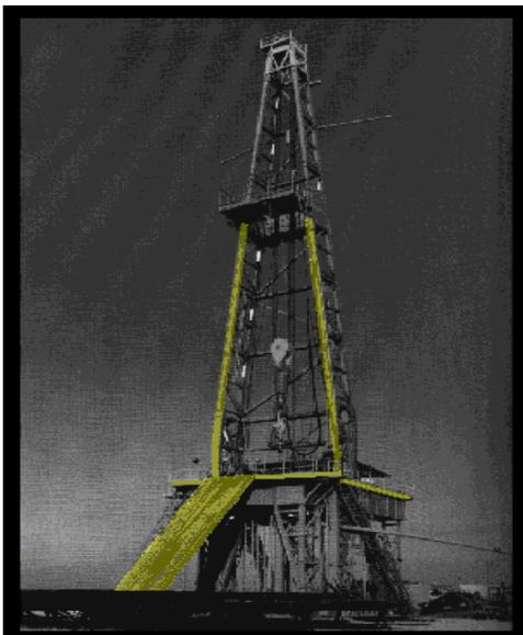
Figura N° 5 Planchada y Rampa de Tubería
