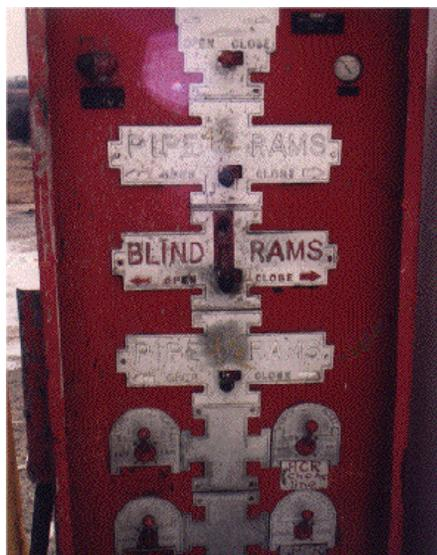
Figura N° 22 Consola del arreglo BOP
