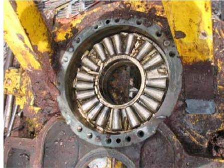
Rodamiento cónico inferior del eje principal
