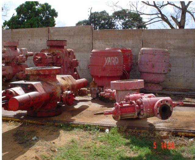
Figura N° 18 Conjunto de BOP's simple, doble y anular
