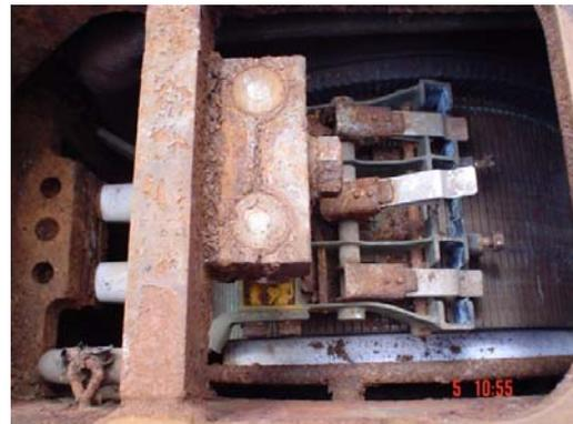
Escobillas de un motor eléctrico DC
