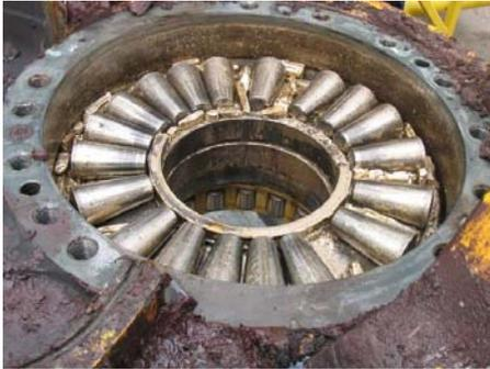
Rodamiento cónico inferior del eje principal
