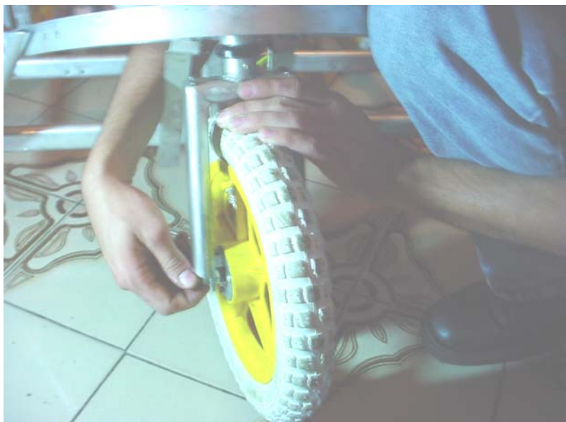
Figura 70: Fijación de la rueda delantera
