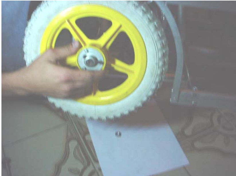
Figura 67: Fijación de las ruedas traseras
