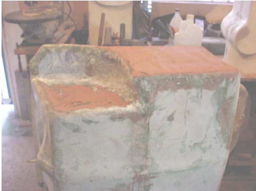
Figura 73: Chasis con la capa de fibra de vidrio colocada.
