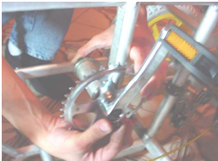
Figura72: Ajuste de la corona transmisora y los pedales
