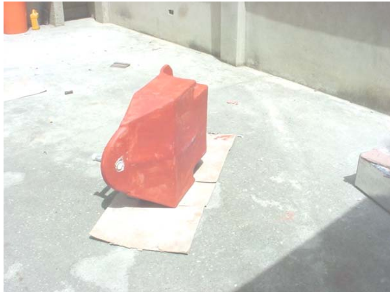
Figura 74: Chasis con la fibra aplicada antes de mejorar el acabado superficial
