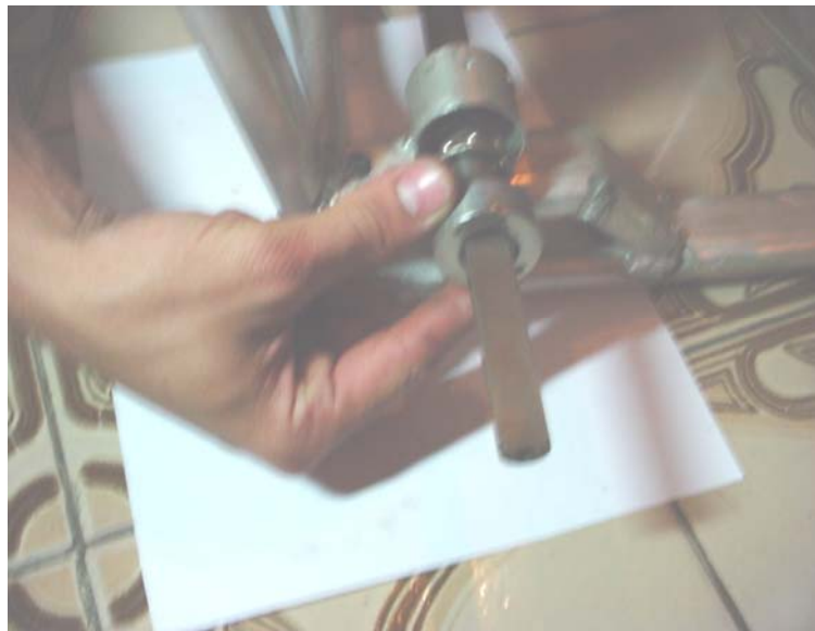
Figura 66: Ajuste de las chumaceras del eje de las ruedas traseras.
