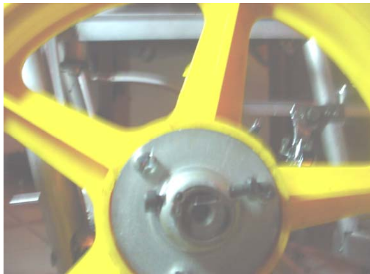
Figura 68: Ruedas fijas con un reten
