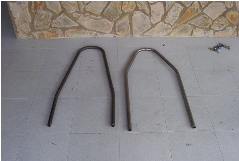
Figura 9.2. Respaldar y posa pie después del proceso de doblado.
