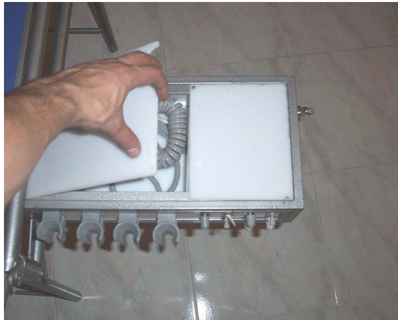
Figura 10.16. Paso 11: apertura de la caja de mando.
