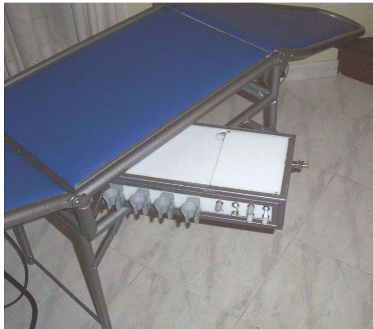
Figura 10.15. Paso 10: desplegar de la bandeja.
