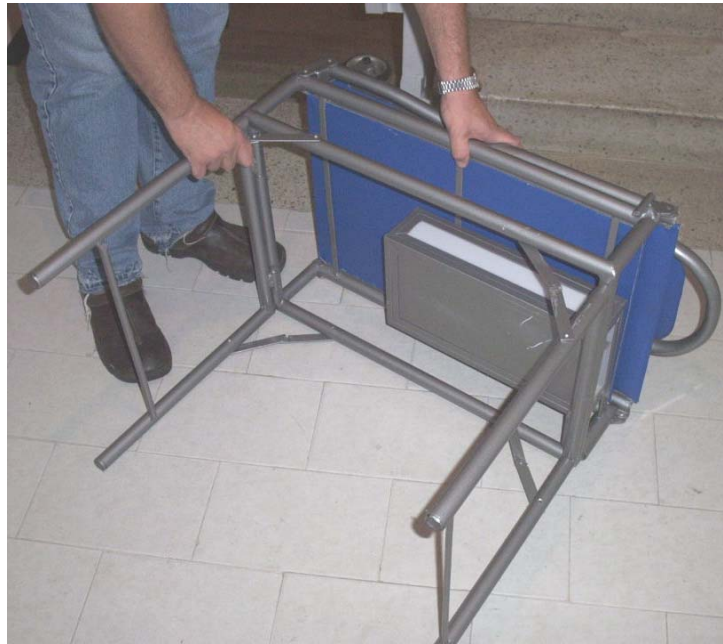
Figura 10.8. Paso 5: se fijan los pasadores.
