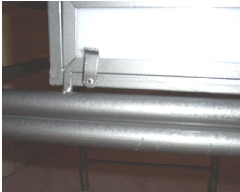
Figura 10.14. Paso 9: quitar el seguro de la caja de mando.
