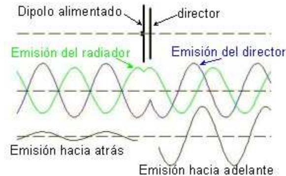
Figura 2.2 Ejemplo de amplificación con dos elementos
