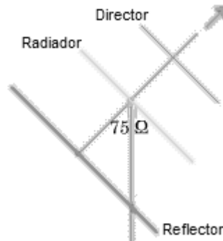
Figura 2. 1. Esquema de una antena Yagi simple
