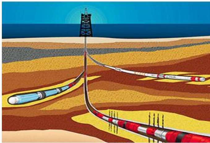
Figura 2.4 Diagrama básico de un pozo multilateral. Fuente (9)
