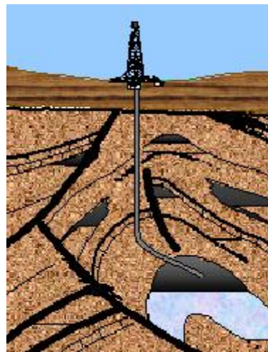
Figura 2.2 Pozo altamente desviado. Fuente (9)
