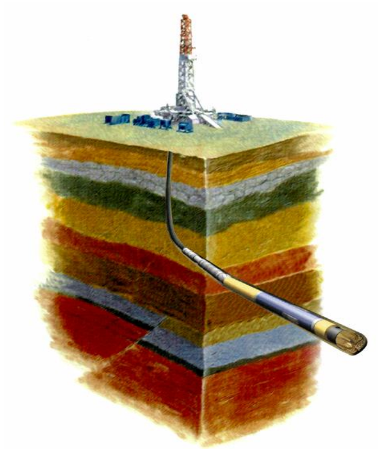
Figura 2.3 Diagrama básico de un pozo horizontal. Fuente (9)
