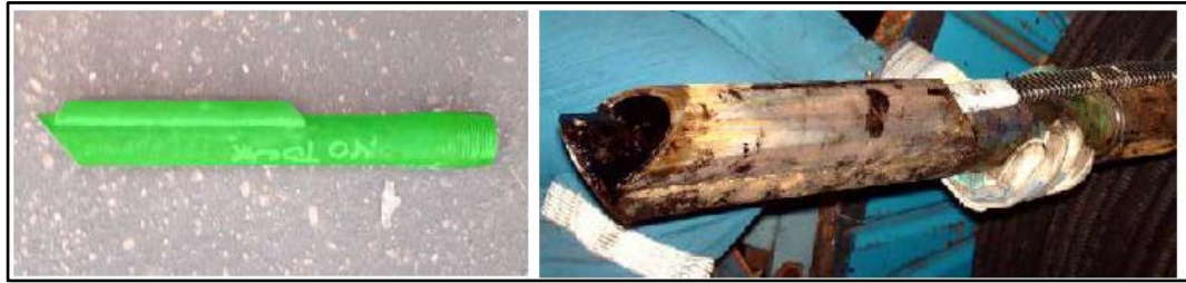
Figura 2. 11: Guarda cable para la tubería de cola.
