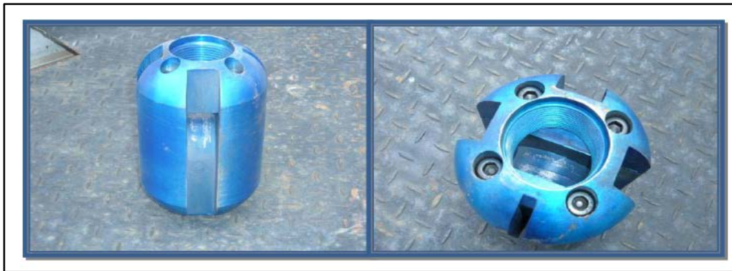
Figura 2. 3: Herramienta de giro/centralizador utilizada por la tecnología Cable #8 AWG. [5]
