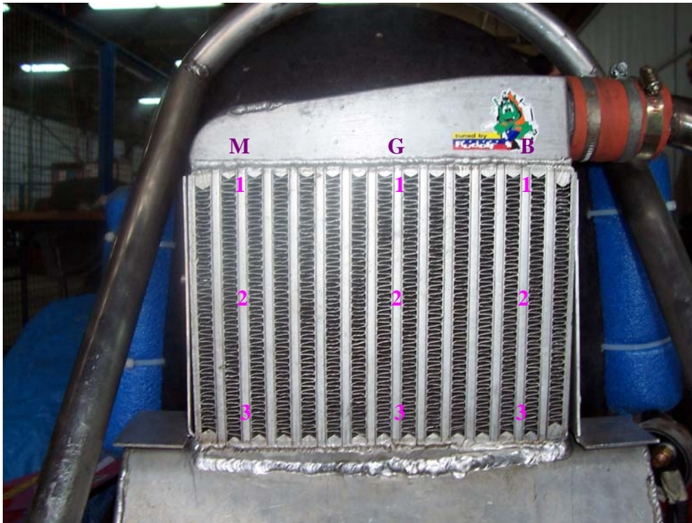
Figura 3.8- Esquema de medición del interenfriador 2005
