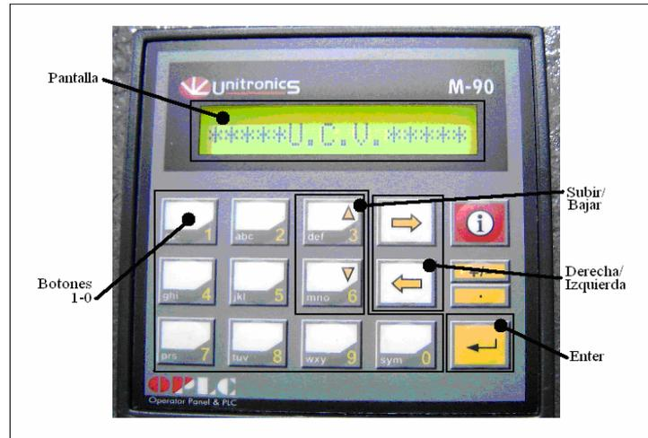
Figura 6.2 Vista frontal dispositivo PLC
