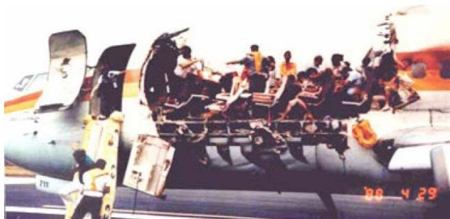
Figura 1.6 Accidente Boeing 737 de Aloha Airlines en 1988
