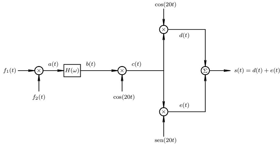
Figura 1.2: Sistema de modulación
