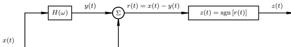
Figura 2.1: Sistema digitalizador
