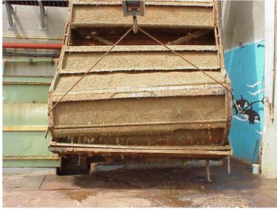
Figura 1. Filtro unidad 6 "A" Tacoa en mantenimiento (Fuente: Tacoa)
