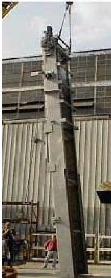
Figura 96. Guardian Bar Screen (Fuente: USFILTER)
