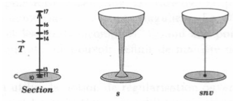
Fig.4.9: Operación de barrido generalizado sobre un círculo c (Marcheix [3]).
