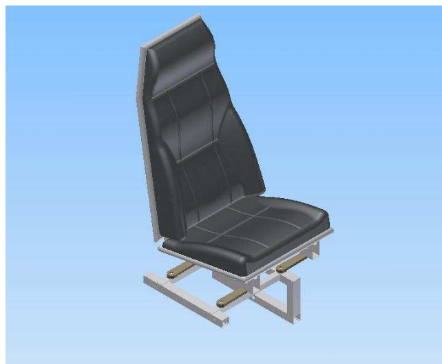
Figura 14: Asiento sobre su base inferior utilizando el mecanismo de cuatro barras rotatorias
