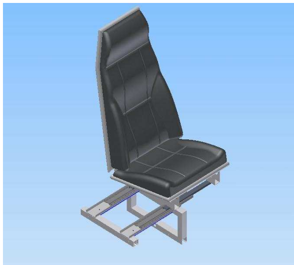
Figura 16: Asiento sobre su base inferior utilizando los rieles telescópicos
