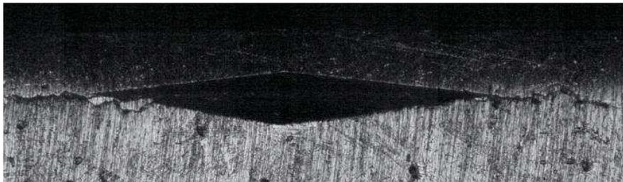
Figura 4.18: Longitud de grieta válida para el ensayo de indentación interfacial
