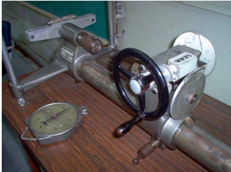
**Figura 1.1** Máquina actual para Ensayos de Torsión Estática ubicada en el Laboratorio de Diseño de la Escuela de Ingeniería Mecánica de la Universidad Central de Venezuela.
