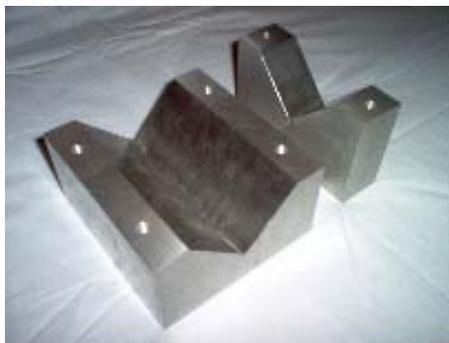
**Figura 8.10** Forma final del soporte de aluminio para caja reductora y rodamientos
