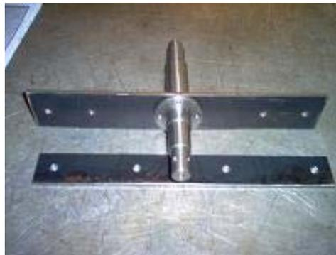
**Figura 8.16** Vista de láminas “A” y “B” del sistema de retorno y del eje central.
