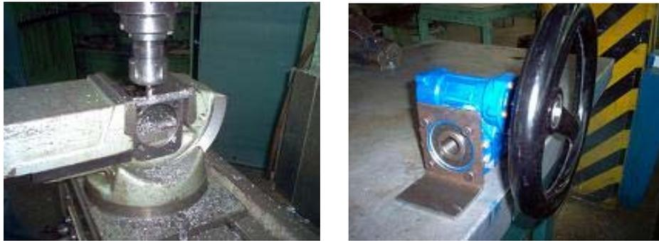
**Figura 8.21** Maquinado de los soportes para la caja
