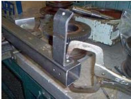
**Figura 8.19** Unión de las soportes de acero (patas) a la bancada.
