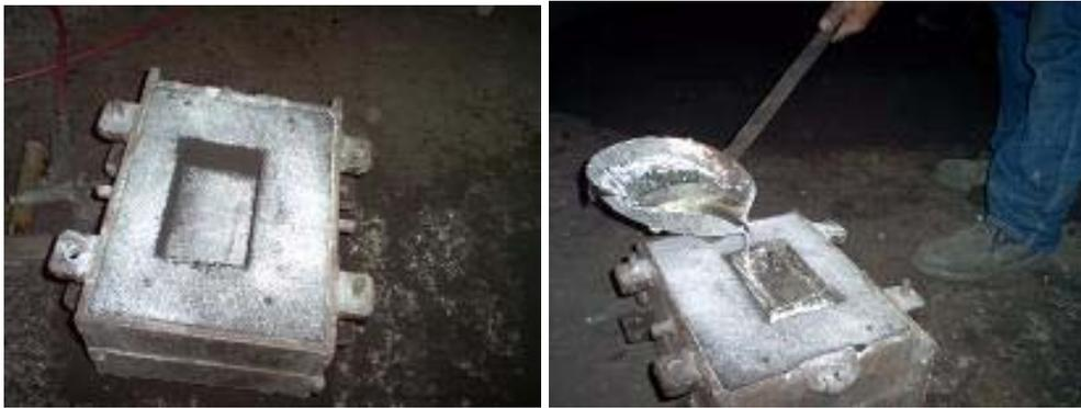
**Figura 8.8** Proceso de vaciado de aluminio en molde de arena
