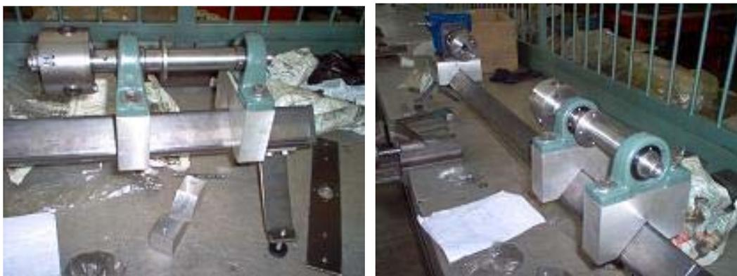
**Figura 8.24** Montaje de rodamientos sobre los soportes de aluminio.
