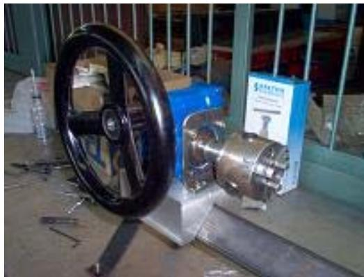
**Figura 8.22** Montaje de los componentes de la caja sobre el soporte de aluminio
