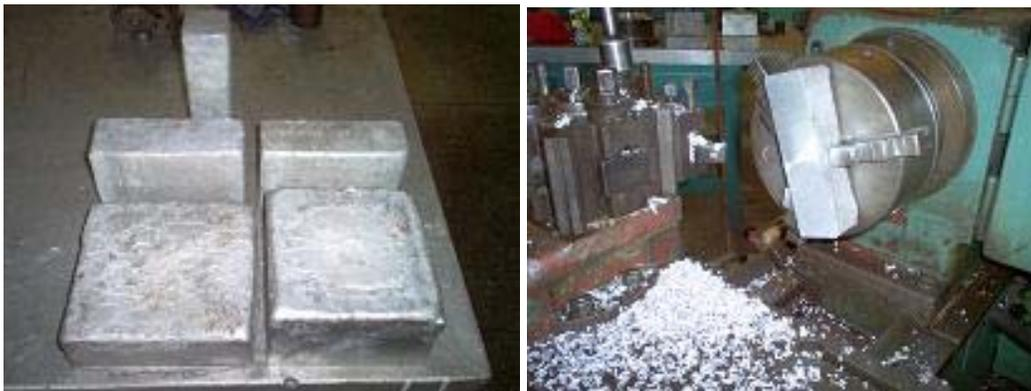
**Figura 8.9** Bloques de aluminio ya fundidos y maquinado del bloque en el torno
