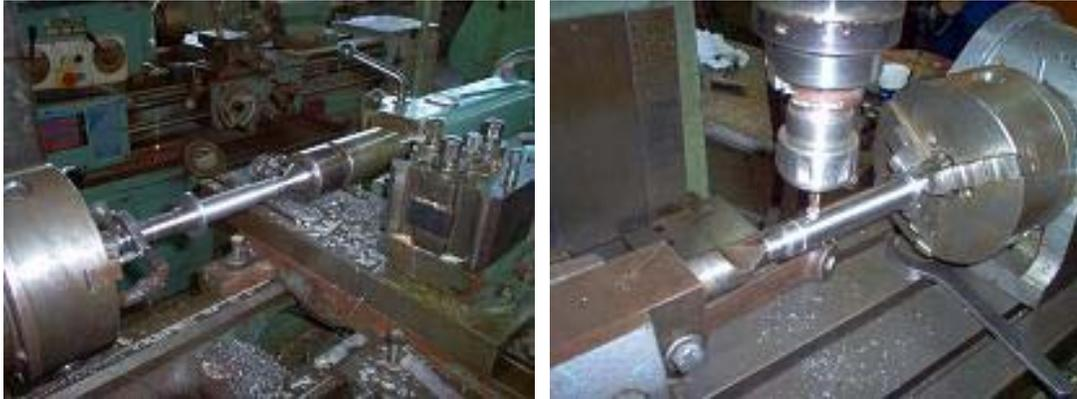
**Figura 8.15** Construcción de ejes centrales de caja reductora y sistema de retorno.
