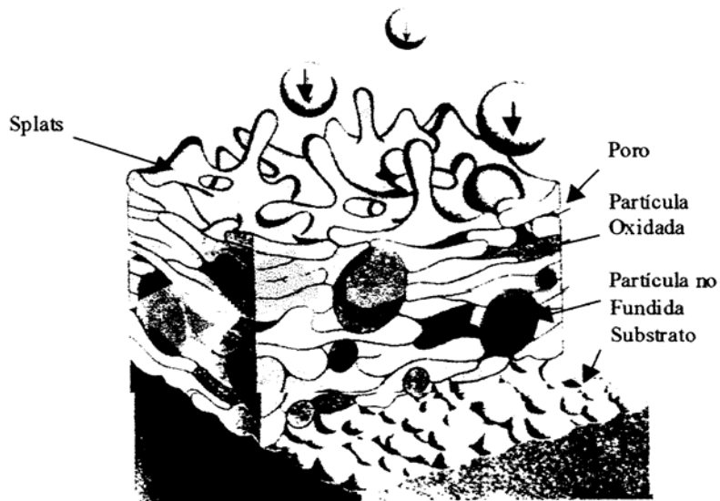
Figura 5: Representación esquemática de la formación del recubrimiento en los procesos de termo-rociado.
