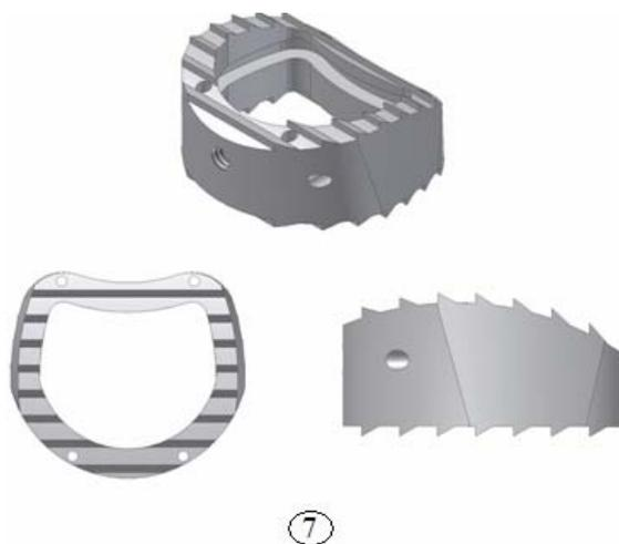
**Figura 4.11 Vista isométrica, lateral y superior del séptimo diseño del implante**
