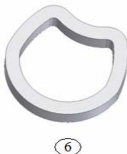
**Figura 4.8** Diseño final, en cuanto a forma se refiere, del implante para la columna cervical
