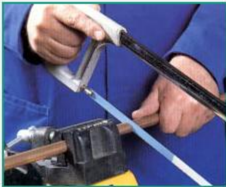
FIGURA 3.25. corte del tubo de cobre
