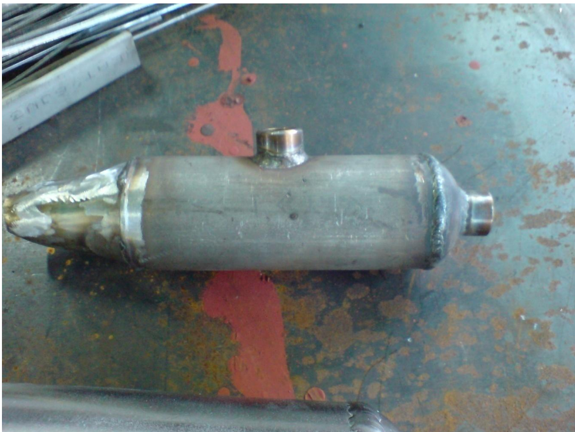
Figura N°4.5 Tanque Mezclador a media construcción
