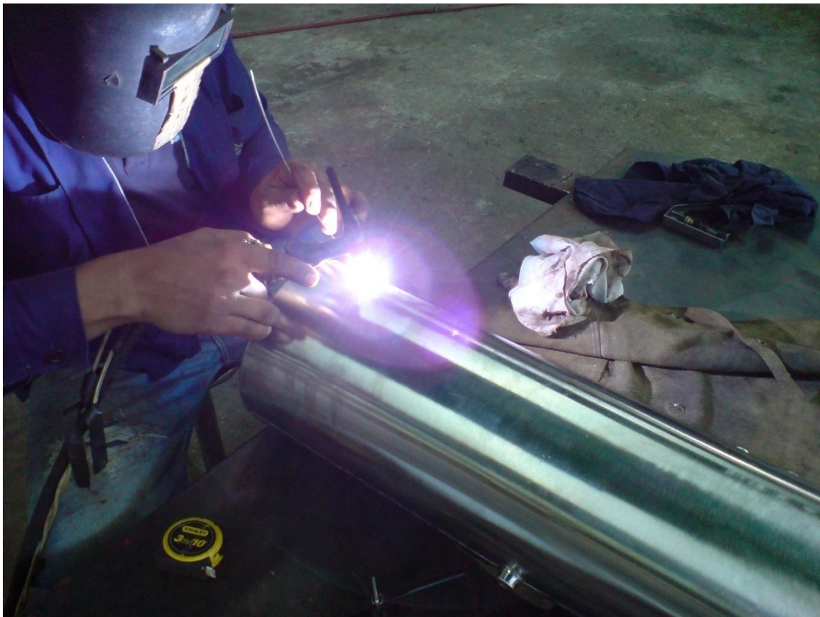
Figura N°4.3 Aplicación del proceso de soldadura TIG con material de aporte (Fuente: Referencia N°1)
