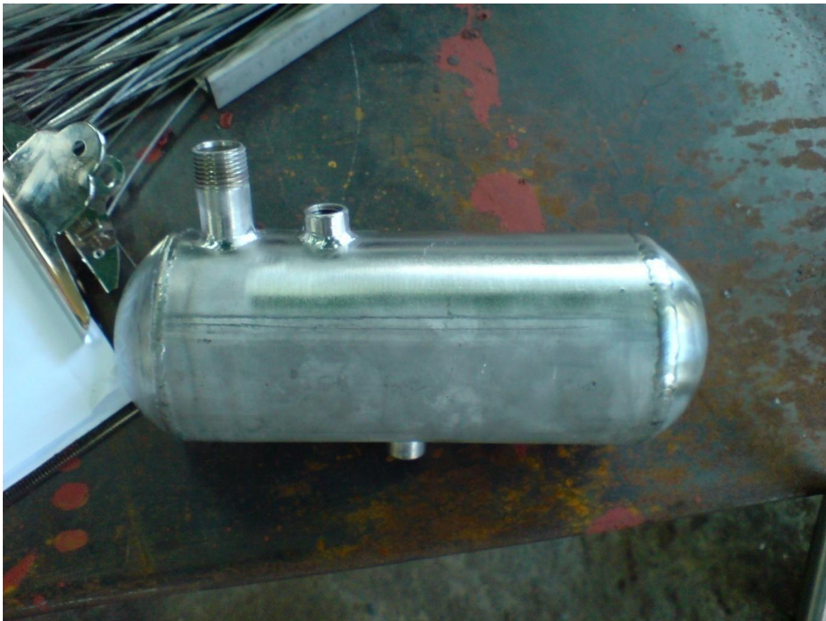
Figura N°4.4 Tanque de limpiador químico sin los soportes (Fuente: Referencia N°1)
