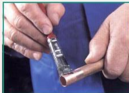
FIGURA 3.29. aplicación del fundente
