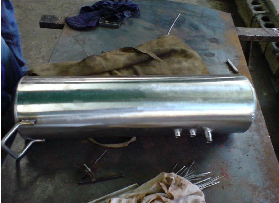
Figura N°4.2 Construcción del tanque de agua (Fuente: Referencia N°1)
