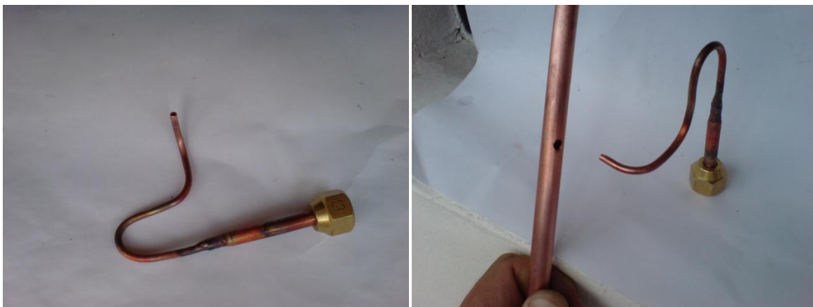
Figura N°4.22 Instalación de tubo delgado en la tubería de agua (Fuente: Referencia N°1)
