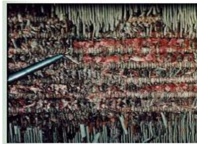
Figura N° 2.4 Serpentín deteriorado por corrosión.
