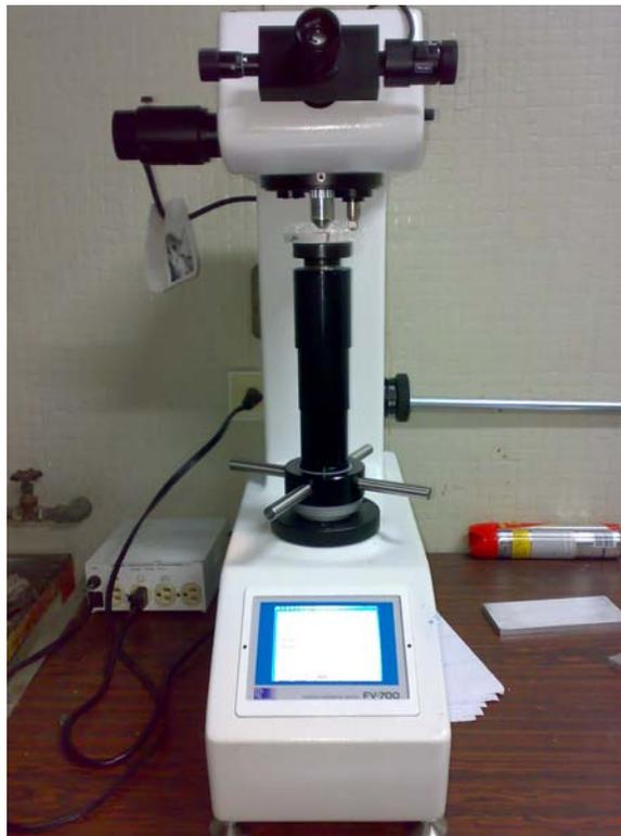
Figura 3.5.1 *Durómetro del laboratorio de lubricación y desgaste de la EIM*
