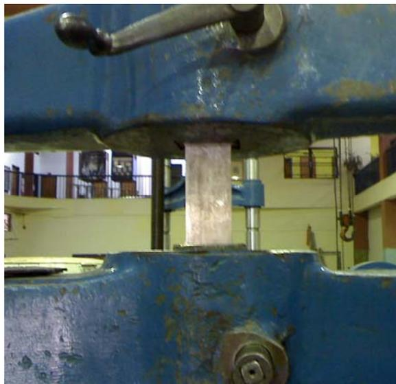
Figura 3.2.3. *Probeta N°3 sometida a tracción para una deformación de 7,8%.*
