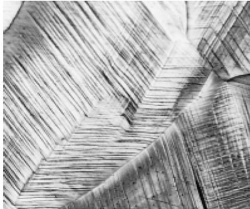
Figura 2.2.1. *Líneas de deslizamiento para una especie de cobre policristalino que fue pulido y luego deformado 173x [2].*
