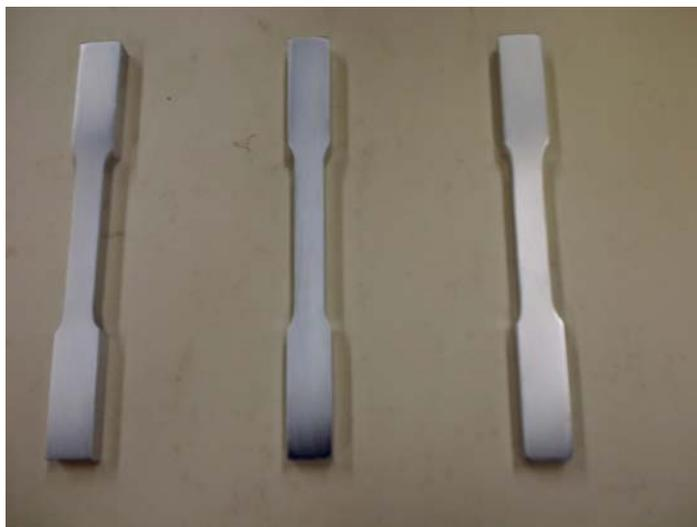
Figura 3.1.1 *Probetas para los ensayos de tracción.*
