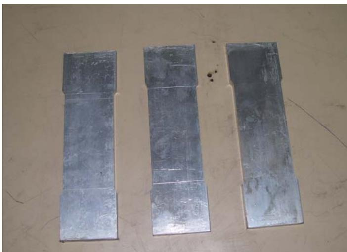
Figura 3.1.2 *Probetas para deformación a porcentaje específico*
