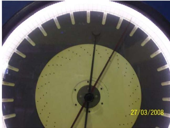
Figura 3.2.4. *Reloj de la máquina de tracción del **IMME** que muestra la carga de 7000 Kg aplicada a la probeta N° 3.*
