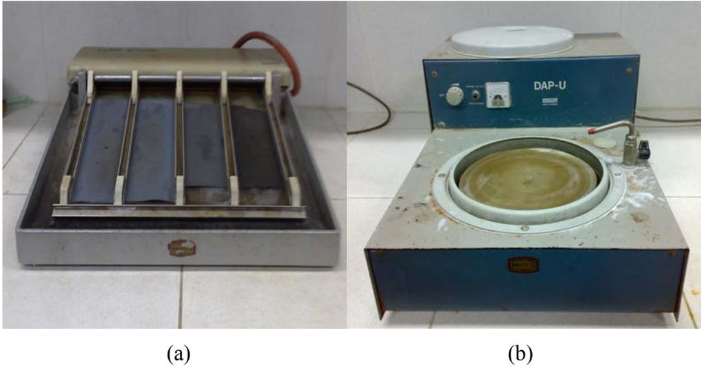
Figura 3.6.1. (a) *Equipo de pulido en forma manual*, (b) *Equipo de pulido con plato giratorio*.
