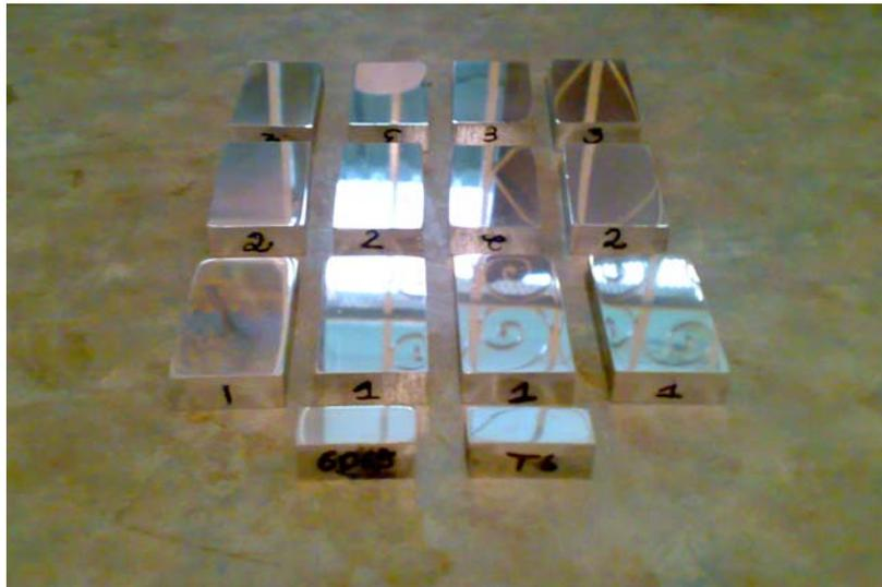
Figura 3.6.2. *Muestras después de ser pulidas para el ensayo metalográfico*.
