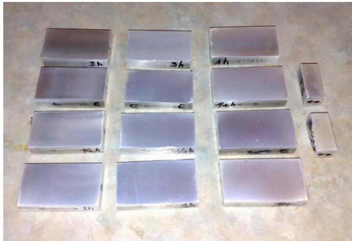
Figura 3.1.4 *Probetas maquinadas para los tratamientos térmicos y mediciones de conductividad.*
