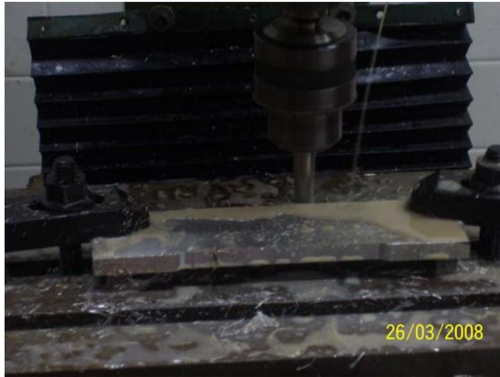
Figura 3.1.3 *Maquinado de probeta para deformación.*
